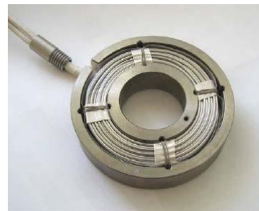
شکل 9- نمونه ساخته شده بیرینگ محوری
